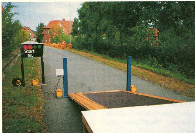
Start: Die blauen Säulen enthalten zwei Lichtschranken, die den Start der Teilnehmer an den Amiga 2000 melden
